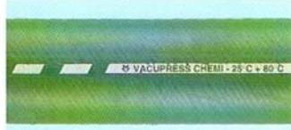
Mangueira flexivel fabricada em borracha termoplástica com espiral de aço e reforço têxtil em poliéster de alta tenacidade. Exterior em cor verde.
