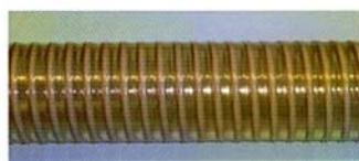
Tubo flexivel fabricado em poliuretano e espiral de PVC rígido anti-choque, dotado de fio de cobre em espiral para descarga eletroestática. Interior liso.
